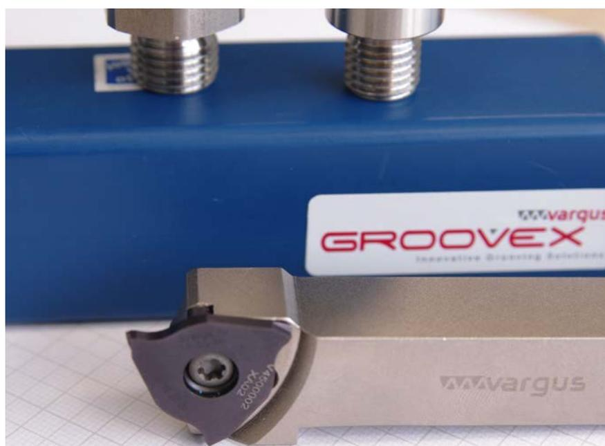
**3 Für hohe Schnitt- und Vorschubgeschwindigkeit: formschlüssig aufgenommene, geschraubte Schneidplatte aus beschichtetem Vollhartmetall mit drei nutzbaren Gewindeschneiden aus dem Standardprogramm Groovex von Vargus** (Bild: Mücke)
