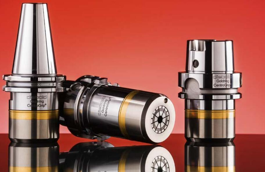
**1** Bei diesem Präzisions-Spannzangenfutter-System mit der Bezeichnung CentroGrip muss der Futterkörper eine Rundlaufgenauigkeit von kleiner als 1 µm einhalten; die speziell dafür gefertigten Spannzangen sind für eine Genauigkeit von unter 2 µm ausgelegt
