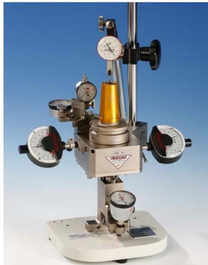
**4 Für einen Hersteller von Präzisionsspanntechnik bietet es sich an, hochwertige Messtechnik selbst zu fertigen. Diebold in Jungingen konnte mit dem Einstieg in die Herstellung von Messgeräten bei der Spannzeugherstellung ein wesentlich höheres Level der Genauigkeiten erreichen als zuvor. Hier ein HSK-Mehrstellen-Kegelmessgerät (Bild: Diebold)**
