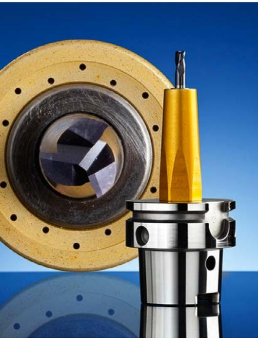
**2** JetSleeve ist ein patentiertes Schrumpffutter, bei dem der Khlschmierstoff (KSS) ber Dsenbohrungen an den Frser gelangt. Die Dsengestaltung bewirkt, dass sich die KSS-Strme berlagern und einen Unterdruck erzeugen, der das Wegschleudern des Mediums verhindert (Bild: Diebold)
