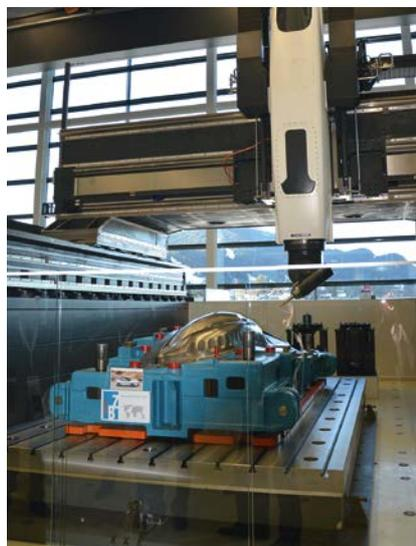
**3 Präzision und Oberflächengüte im XXL-Format: Das neue Hochgantry-BAZ DMU 600 G linear mit Linearantrieben**
