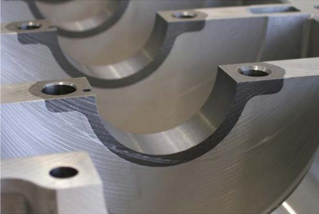
**2** Eingegossene Lagerhalbschalen aus Gusseisen mit Kugelgrafit GJS 600 in einem Kurbelgehäuseunterteil aus AlSi9Cu3. Die spanende Bearbeitung der Lagerstege ist wegen der unterschiedlichen Werkstoffeigenschaften besonders anspruchsvoll (© Mapal)
