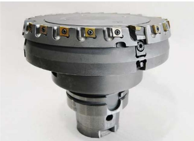
**3** Der Schrapp- und der Schlichtvorgang an den Lagerhalbschalen werden bei ZMT Automotive getrennt voneinander ausgeführt, und zwar mit diesen maßgeschneiderten Werkzeugen von Mapal (© Mapal)
