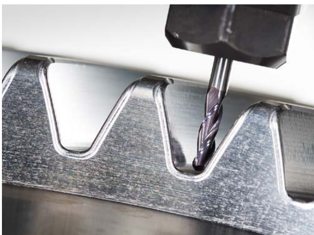
3 Ein DSM-Torus-Schaftfräser beim Fertigschlichten von Zahnflanken
