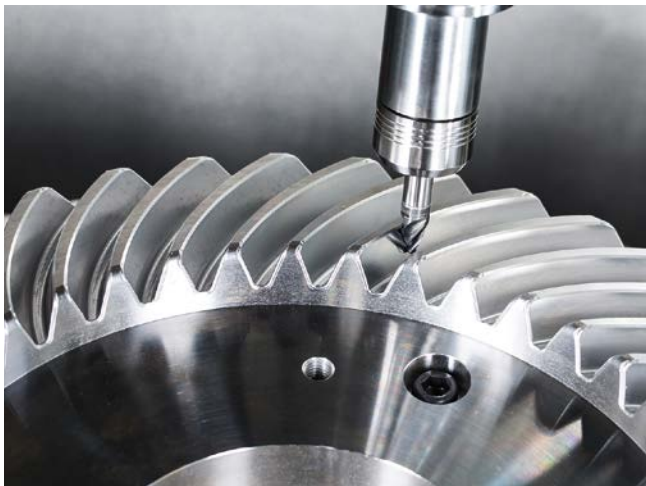
2 Bei einem Kegelrad übernimmt ein konischer Fräser des Typs DGZ sowohl das Vorschlichten als auch das Fertigschlichten der Zahnflanken und bearbeitet abschließend den Fußkreisradius
