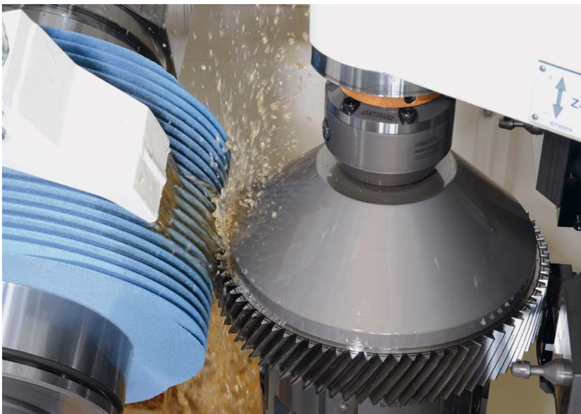
1 Verzerrungsfreies Wälzschleifen einer Schrägverzahnung (© Liebherr-Verzahntechnik)
