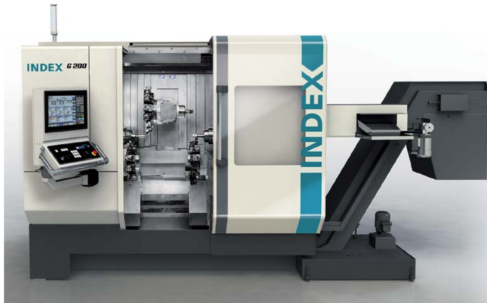
1 G200 der zweiten Generation: Das Index-Drehfräszentrum vereint hohe Flexibilität und Produktivität. Trotz deutlich höherer Leistungsdichte benötigt es nur nahezu die gleiche Aufstellfläche wie das Vorgängermodell (© Index-Werke)
