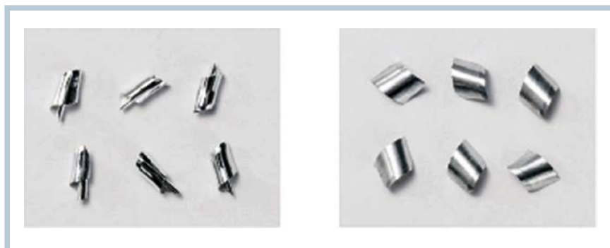
4 Späne aus der Bearbeitung einer Aluminiumlegierung A5052. Die Späne, die mit dem Schneidstoff PDL025 erzeugt wurden, sind glänzend und spiralförmig (links), wogegen das Werkzeug aus unbeschichtetem Hartmetall matte Späne erzeugt (© Kyocera)
