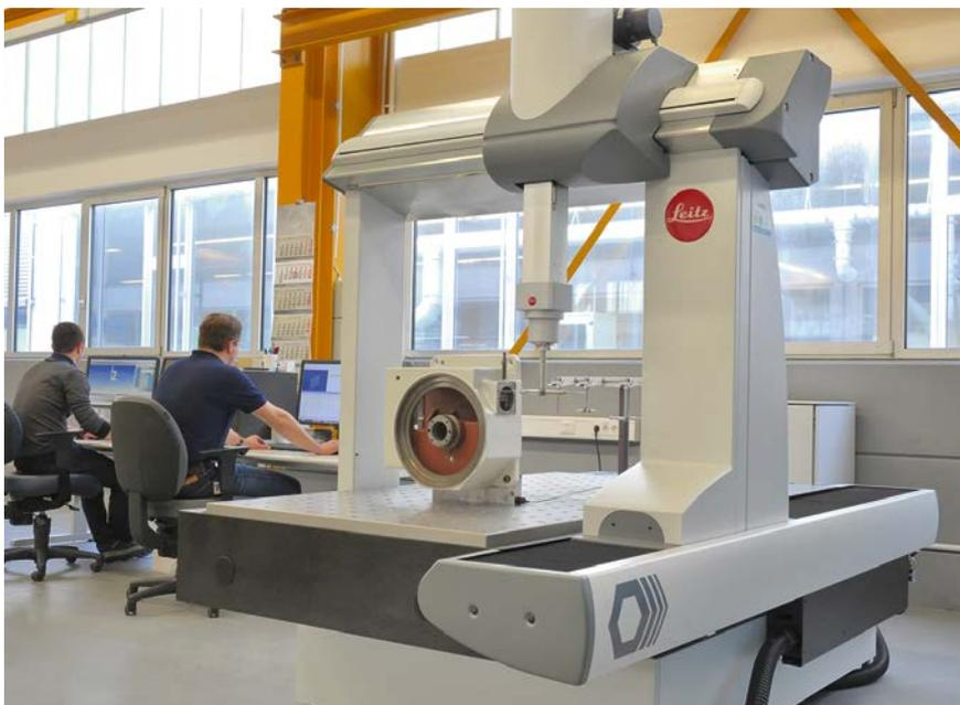
**4** Schnelle Einzelpunktantastung für alle typischen Messaufgaben sowie das High-Speed-Scanning für Form- und Profilmessungen bietet das Leitz Reference HP (© Hexagon)
