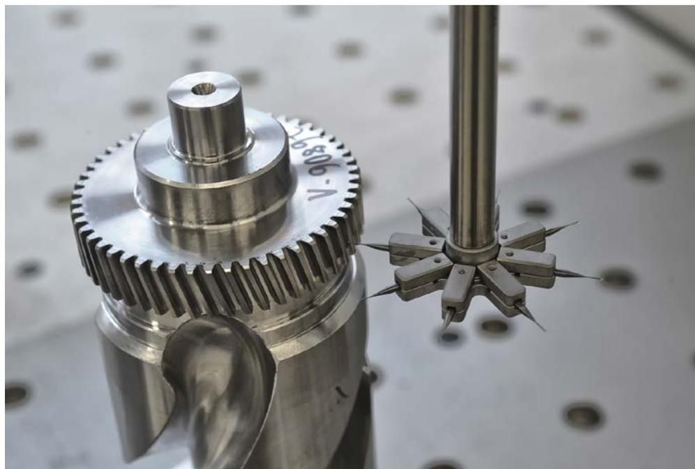
**1** Koordinatenmessmaschine als Verzahnungsmesszentrum: ideale Verbindung aus Präzision, Schnelligkeit und Flexibilität (© Hexagon)
