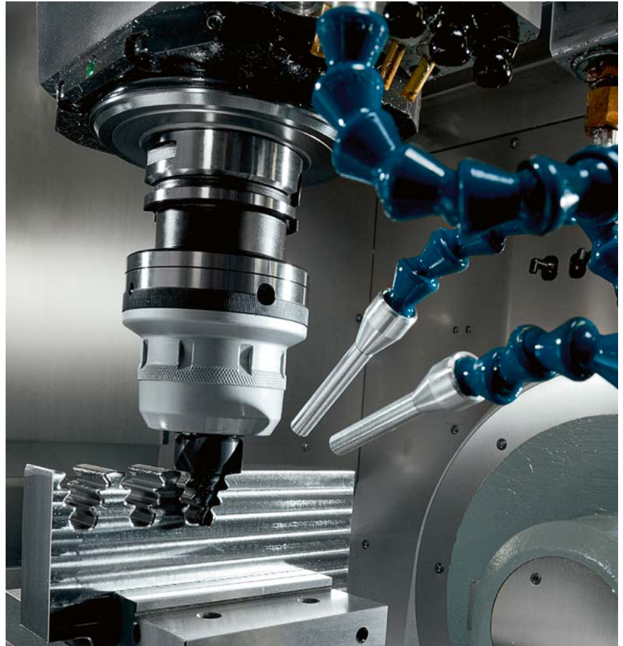
1 Im Zerspantungprozess von Superlegierungen, hochwarmfesten Stählen, Titan und ähnlichen Hightech-Materialien schlummert enormes Optimierungspotenzial. Neue Kühlschmierstrategien und -verfahren können die Produktivität maßgeblich erhöhen (© Rother)
