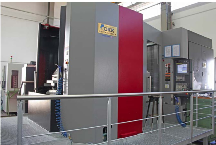
4 Die OKK HM-X6000: leistungsstarkes Horizontal-BAZ mit guter Zugänglichkeit dank Wechseltisch; aufgrund der fünf CNC-Achsen fallen die Spannvorrichtungen selbst bei Bauteilen, die in verschiedenen Schräglagen bearbeitet werden müssen, einfach aus (© Teamtec)
