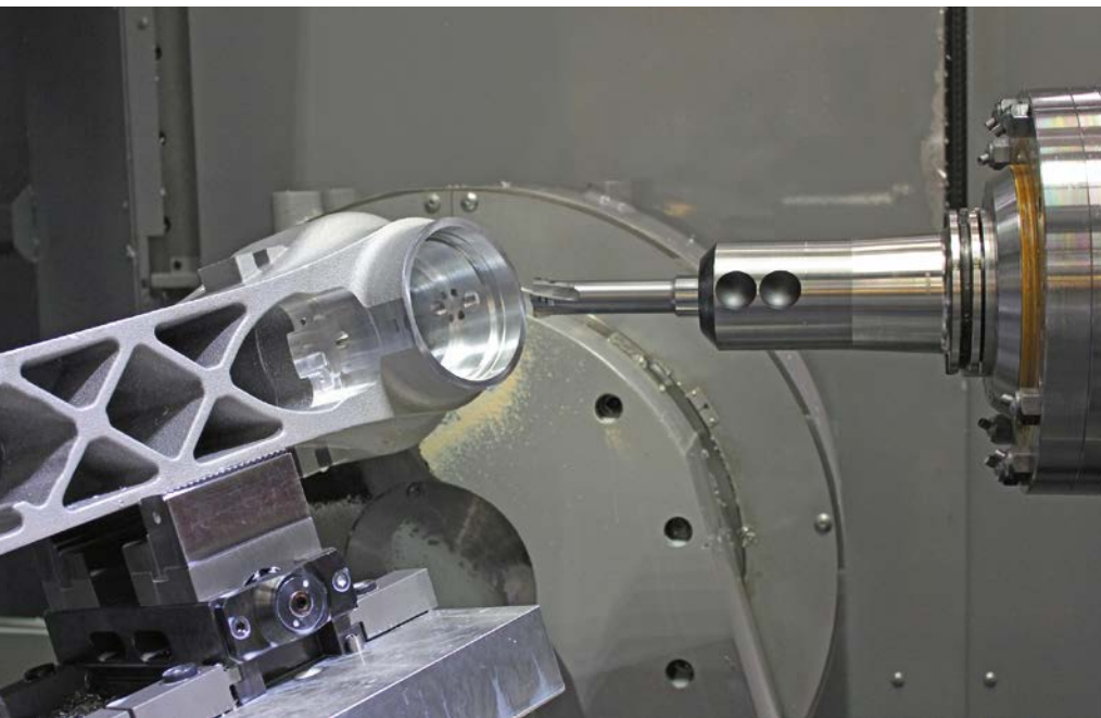
1 Das horizontale 5-Achs-BAZ OKK HM-X6000 liefert bei der Bearbeitung von Aluminium-Integralbauteilen bei CNC-Dienstleister Jung Ergebnisse mit hoher Konturtreue und Oberflächengüte (© Teamtec)
