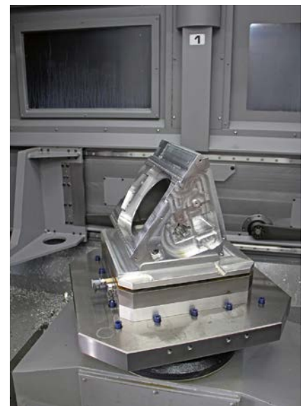
4 Die OKK HM-X6000: leistungsstarkes Horizontal-BAZ mit guter Zugänglichkeit dank Wechseltisch; aufgrund der fünf CNC-Achsen fallen die Spannvorrichtungen selbst bei Bauteilen, die in verschiedenen Schräglagen bearbeitet werden müssen, einfach aus (© Teamtec)
