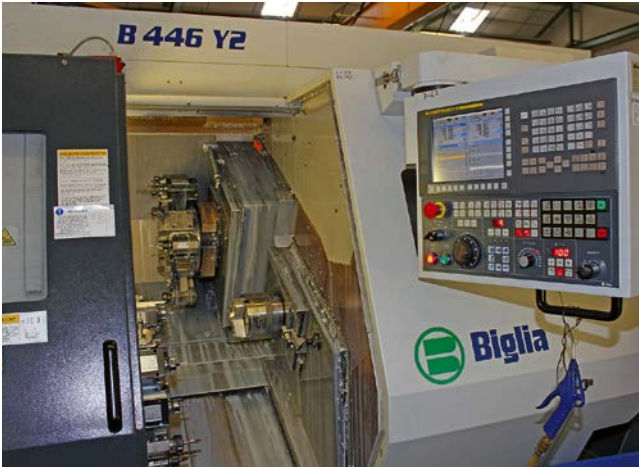
2 Flexible Ergänzungsmaschine: Auf der Biglia B 446Y2 kann Jung kurzfristig alle benötigten Bolzen, Hülsen, Anschläge und Achsen selbst herstellen (© Teamtec)
