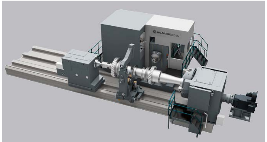
1 ProfiTurn M: die nächste Generation der Groß-Drehfräsmaschinen für die Komplettbearbeitung komplexer, rotationssymmetrischer Teile; hier in Ein-Bett-Ausführung (© WaldrichSiegen)
