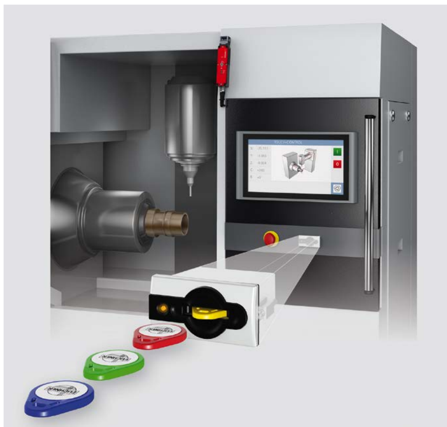
1 EKS heißt ein elektronisches Verfahren zur sicheren Betriebsartenwahl an Werkzeugmaschinen, mit dem – gesetzes- und normenkonform – personenindividuelle Berechtigungen zugeordnet und nachvollzogen werden können. Die EKS-Lesestation ist üblicherweise im Bedienpanel der Maschine installiert (© Euchner)
