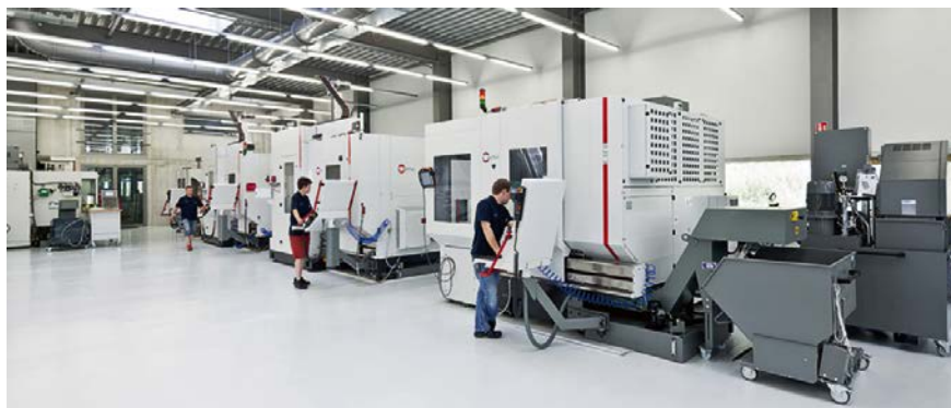
2 Die Parade der Hermle-5-Achs-BAZ zur varianten- und stückzahlflexiblen Fertigung von Chirurgie-Instrumenten und medizintechnischen Geräten: C 22 U mit PW 150, C 40 U sowie C 12 U mit RS 05 im neuen Produktionszentrum von Fetzter Medical (© Hermle)
