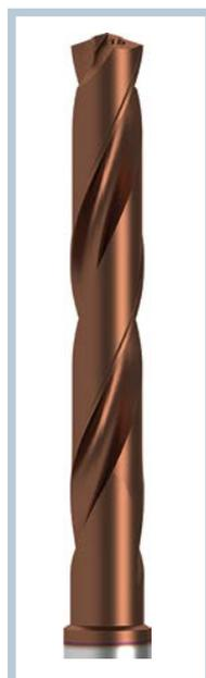
**4** Mit der Schicht Endurum veredelter Bohrer. Die Schicht in Nanolagen-Struktur und mit reduziertem Al-Anteil befähigen das Werkzeug zur Bearbeitung niedriglegierter Stähle wie Kohlenstoff-, Automaten- und Manganstahl im optimierten Modus (© Gühring)
