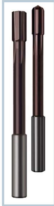
**3** Mit Signum beschichtete Reibahle. Die Schicht gilt mit einer Härte von 5500 HV als eine der härtesten nitridischen Schichten und verliert diese Eigenschaft auch nicht bei großer Hitze (© Gühring)
