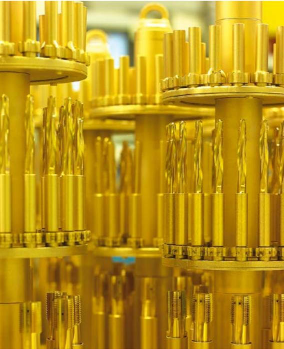
**2** In einem solchen sogenannten Beschichtungskarussell erfahren Bohrer, Reibahlen oder Gewindewerkzeuge eine anwendungsorientierte Oberflächenveredelung (© Gühring)
