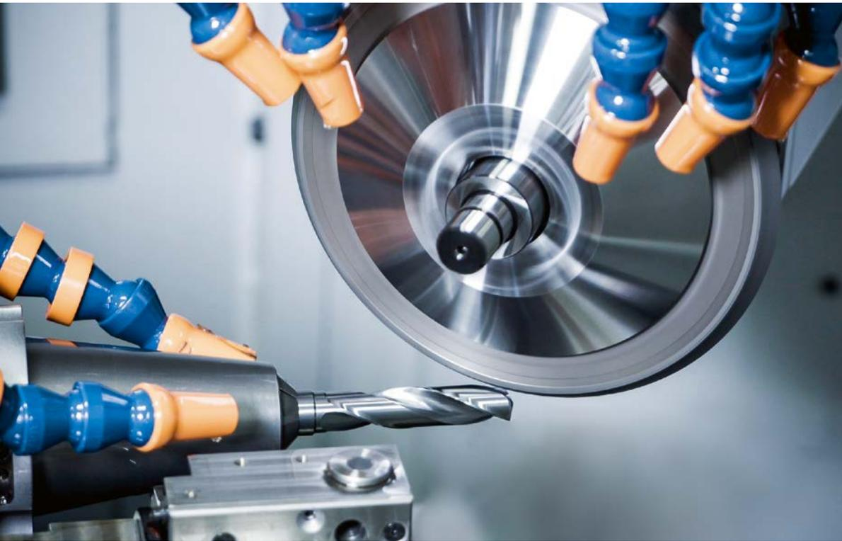
**1** Das Nachschleifen rotativer Zerspanungswerkzeuge gehört zu den anspruchsvollsten Aufgaben in der Fertigungstechnik. Vor der Wiederbeschichtung erfolgt nebst dem Nachschliff der Makrogeometrie auch die Wiederherstellung der Mikrogeometrie
