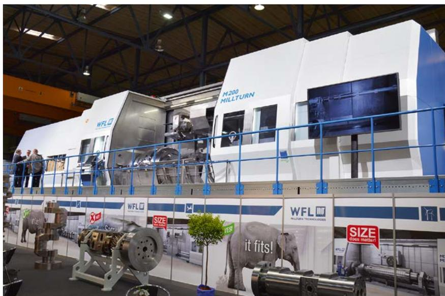
**1** Der Gigant: Die 2016 erstmals präsentierte M200 Millturn mit ihrer besonderen Heavy-Duty-Dreh-Bohr-Fräseinheit für die schwere Komplettbearbeitung riesiger Bauteile thronte erhaben in einem eigenen Hallenschiff (© Hanser)
