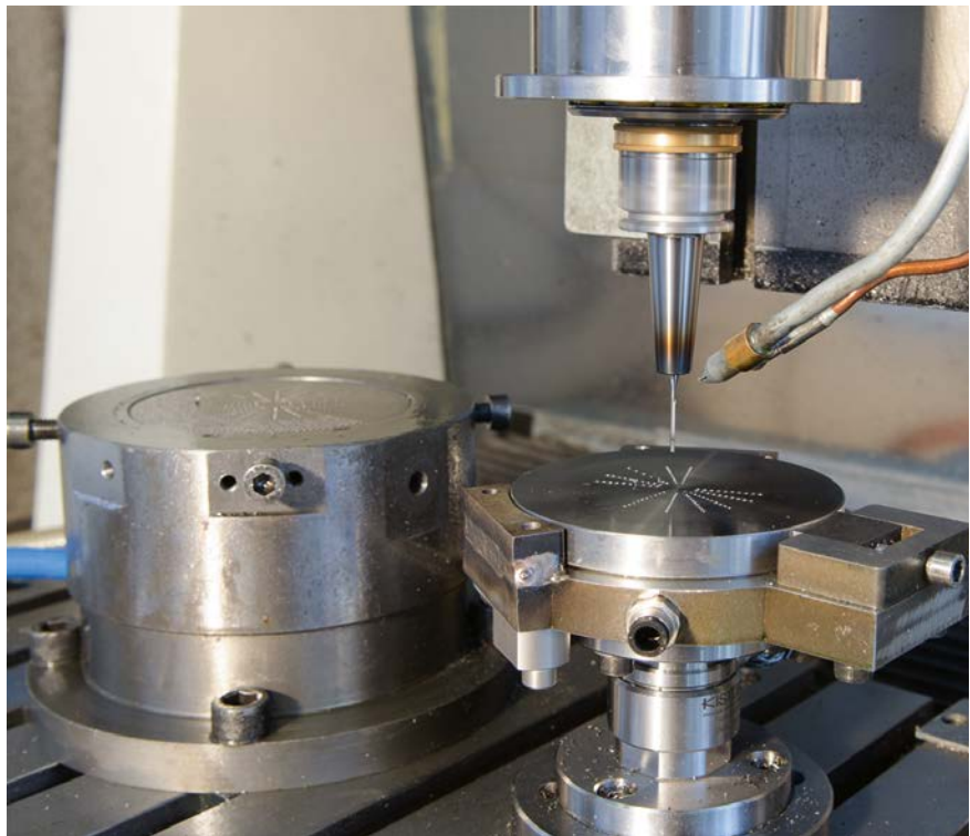
1 Mit dieser Versuchsanordnung wurde die Leistungsfähigkeit von Wendeltiefbohrern mit behandelter und unbehandelter Spanfläche bei der Edelstahlbearbeitung untersucht. Links Plattform zur Standwegmessung; rechts Plattform zur Messdatenerfassung (© swf)
