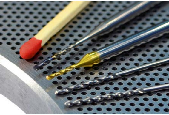
2 Werkzeuge zum Bohren von Tieflöchern mit d < 1,5 mm auf dem Segment einer Lochscheibe für die Lebensmittelindustrie (© swf)
