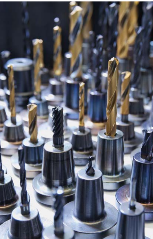
2 Ungefähr einhundert Präzisionswerkzeuge hält man bei Dümmel fertig gespannt und ausgemessen in Adaptern für die Fertigung bereit (© Sauter Feinmechanik)
