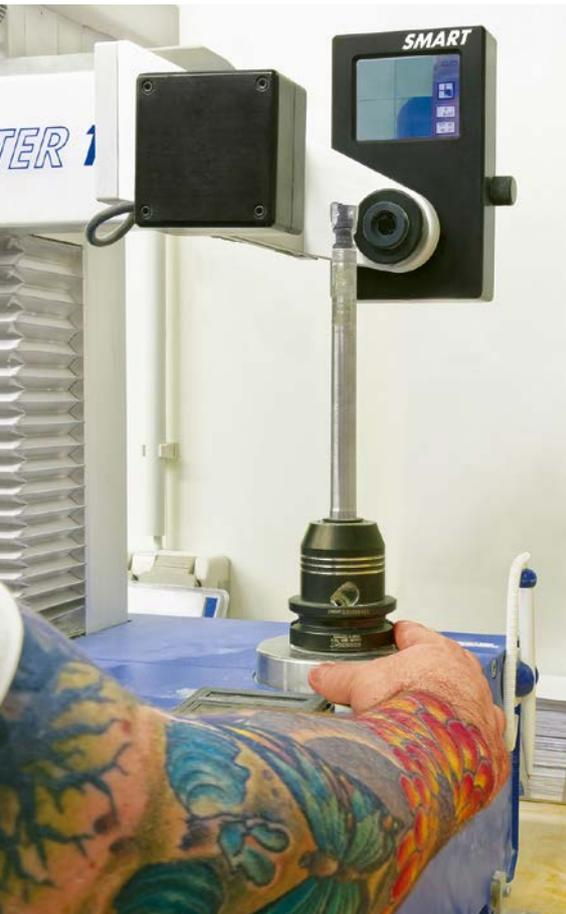
**4 Die Zerspannungswerkzeuge lassen sich schnell im Hydrodehnspannfutter Tendo E compact spannen und vermessen** (© Schunk)
