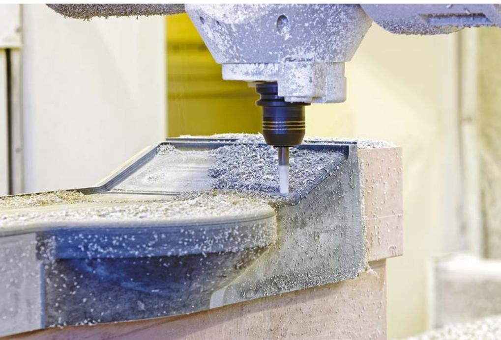
**1 Minimale Vibrationen beim Fertigen von Flugzeug-Waschtischen aus Mineralwerkstoff stellen Hydrodehnspannfutter Tendo E compact von Schunk beim Aerospace-Zulieferer Schüsckhe sicher** (© Schunk)
