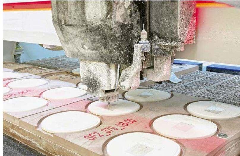
**3** Damit sich die Farbfüllung später gut mit der Waste-Flap verbindet, ist eine definierte Rautiefe erforderlich. Mithilfe der Polygonspannfutter werden die erforderlichen Oberflächenwerte präzise und zuverlässig erreicht (© Schunk)
