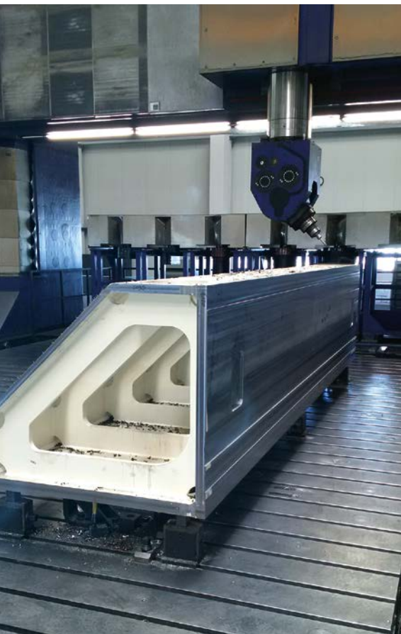
4 Bearbeitung eines Querträgers auf der Schiess Vertimaster VMG 6 (© Schiess)
