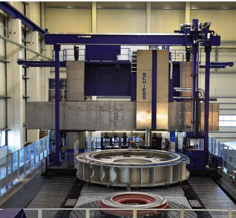
3 Eine VertiMaster VMG 6, wie sie bei Schiess seit 2012 in der eigenen Fertigung im Einsatz ist (© Schiess)
