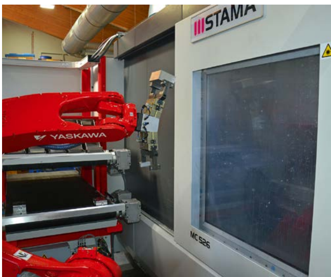
5 Roboterzelle mit geringen Rüstzeiten, wirtschaftlich ab kleineren bis mittleren Losgrößen: MC 526 von Stama mit FMB-Unirobot für die Komplettbearbeitung von Einlegeteilen in Mehrfachspannung (© Hanser)
