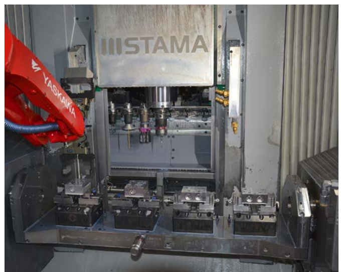
5 Roboterzelle mit geringen Rüstzeiten, wirtschaftlich ab kleineren bis mittleren Losgrößen: MC 526 von Stama mit FMB-Unirobot für die Komplettbearbeitung von Einlegeteilen in Mehrfachspannung (© Hanser)
