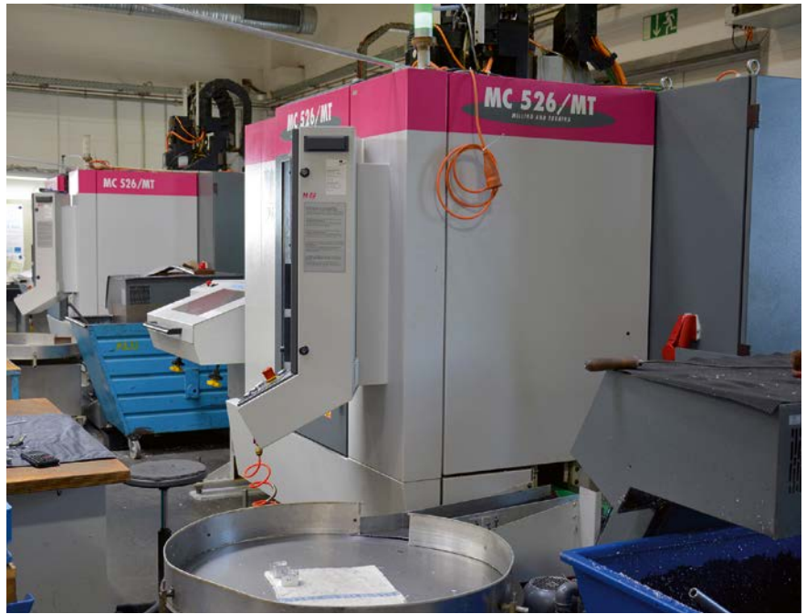
4 Automatisiert dank Stangenlader und Fertigteile-Rundspeicher: Den Einstieg in die Fräsdrehtechnik mit MT-Maschinen von Stama kombinierte Kögel mit der Arbeit von der Stange und eigenentwickelten Automationslösungen für mannlose Geisterschichten (© Hanser)
