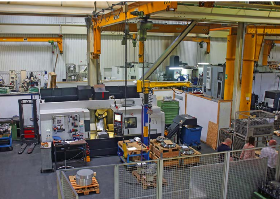
2 Mit 15 CNC-Werkzeugmaschinen und zwei Portalfräsmaschinen fertigt H&M im Dreischichtbetrieb vielfältige, oft komplexe Bauteile in zumeist kleiner Stückzahl und mit hohen Härte-Kennwerten (© Klaus Vollrath)
