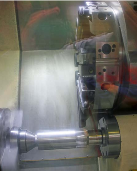
4 Blick in den Arbeitsraum beim Außendrehen des Ventilbauteils. Von den vier Drehmeißeln sind zwei für das Links- und zwei für das Rechtsdrehen vorgesehen
