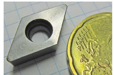
5 Bei den Versuchen zur Schlichtbearbeitung im unterbrochenen Schnitt bei H&M hielten CBN-Wendeschneidplatten von ZCC-CT wie diese den Beanspruchungen stand (© Klaus Vollrath)
