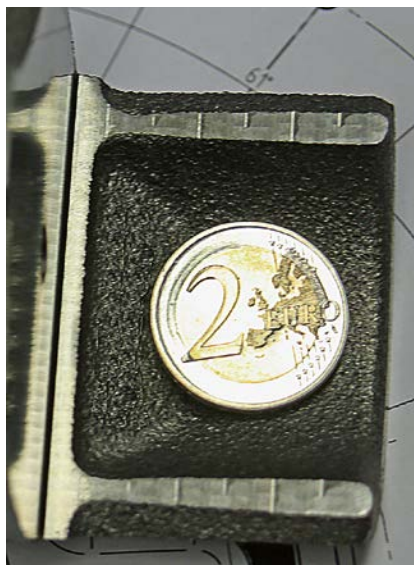
3 Zu den schwierigsten Aufgaben gehört die Fertigung von Ventilbauteilen für Kältemaschinen. Dabei schränkt die von einem exzentrischen ›Lappen‹ – hier unter der Münze – erzeugte Unwucht die Drehzahl ein (© Klaus Vollrath)
