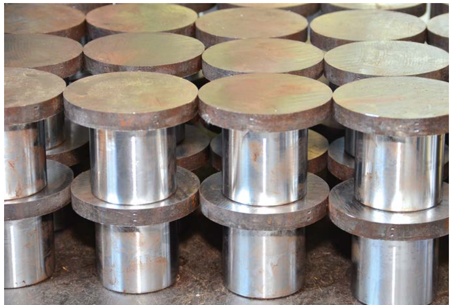
5 Die erste Aufgabe, die PHM an Seco stellte, war die Prozessoptimierung beim Schruppen der Rohteile. Die Standmenge verdoppelte sich bei kürzerer Eingriffszeit
