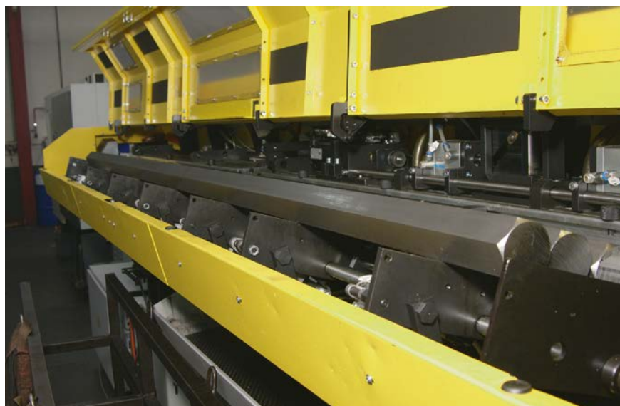
1 Besonders stabil im Aufbau, führen die Stangenlader turbo 20-100 von FMB auch schwere, bis 3000 mm lange (Profil-)Stangen mit bis zu 100 mm Durchmesser sicher zu (© FMB)
