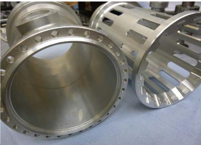
**4** Zwei weitere Bauteile, die wie gemacht sind für die Komplettbearbeitung in einer Aufspannung auf der M35-G Millturn, die dafür reichhaltig inklusive eines Revolvers und Gegenspindel ausgestattet wurde (© Audi)
