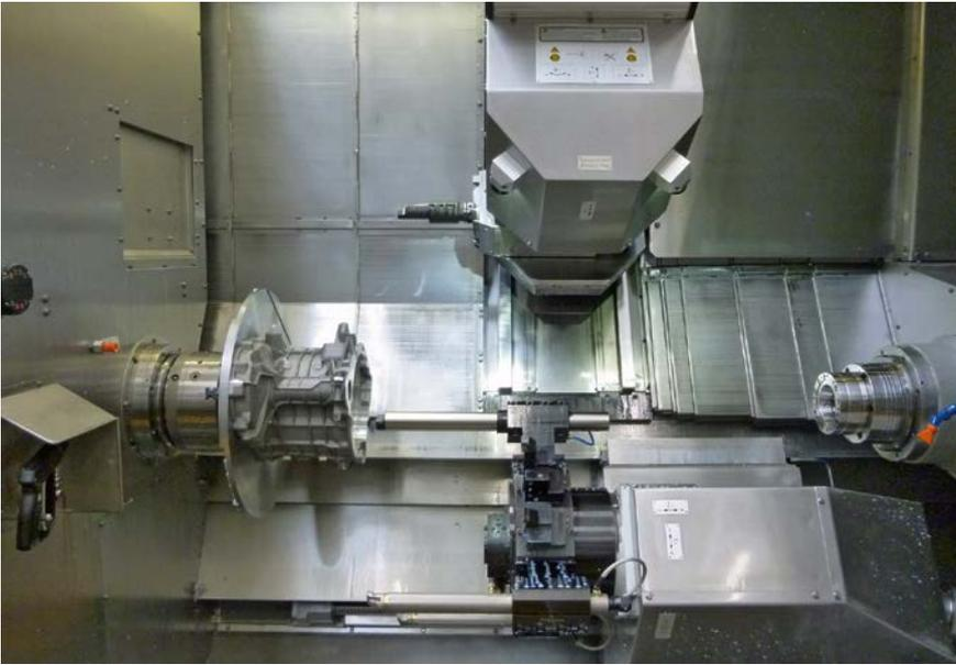
**5** Ganz in ihrem Metier: Ausspindeln eines E-Maschinen-Gehäuses mit lang auskragenden Werkzeugen auf der Millturn (© Audi)
