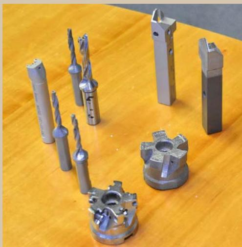
Werkzeuge und Werkzeugkomponenten, die bei Iscar in Tefen additiv gefertigt wurden. Im Sektor 3D-Druck engagiert sich der Hersteller seit jüngster Zeit besonders intensiv
