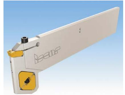
**3** Eines der Produkt-Highlights: die neueste Version des Stechwerkzeugs Cut-Grip. Sein Schneidensektor ist vibrationsdämpfend ausgeführt, mit dem Ergebnis einer deutlich besseren Nutoberfläche und einer vervielfachten Werkzeugstandzeit (© Hanser)
