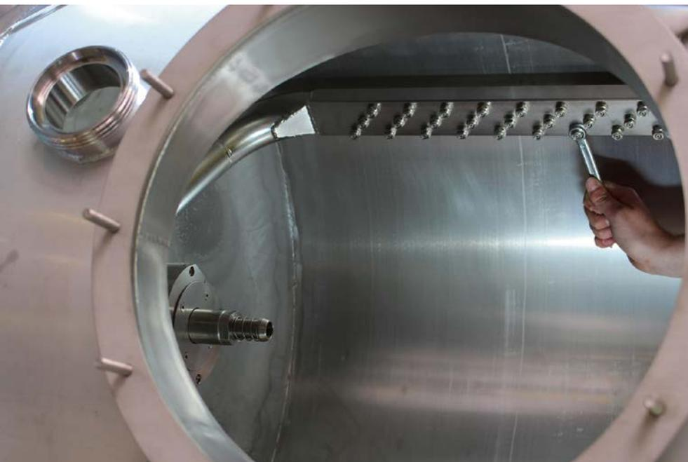
**2 Die Anpassung der Düsenwinkel sowie der Pumpendrucke können die Reinigungsmaßgeblich bestimmen. Mittels anforderungsgerechter Düseneinstellung lässt sich der Reinigungsprozess optimieren** (© Mafac)
