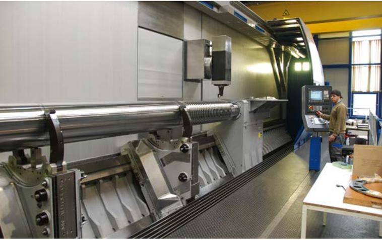
**2** Auf dieser mpmc können bei einer Spitzenweite bis 10 m Bauteile bis 20 t Gewicht zwischen Spitzen bearbeitet werden
