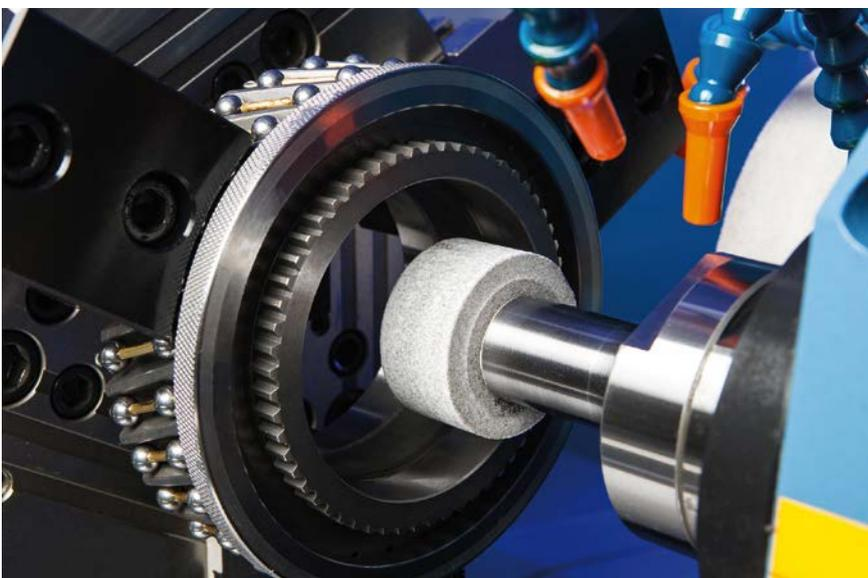
**1** Innenansicht der Zema-Korundscheifmaschine vom Typ Flexa: die Maschine löst hochpräzise bis zu drei Schleifaufgaben: Innen-, Außen- und Gewindeschleifen (© Junker)
