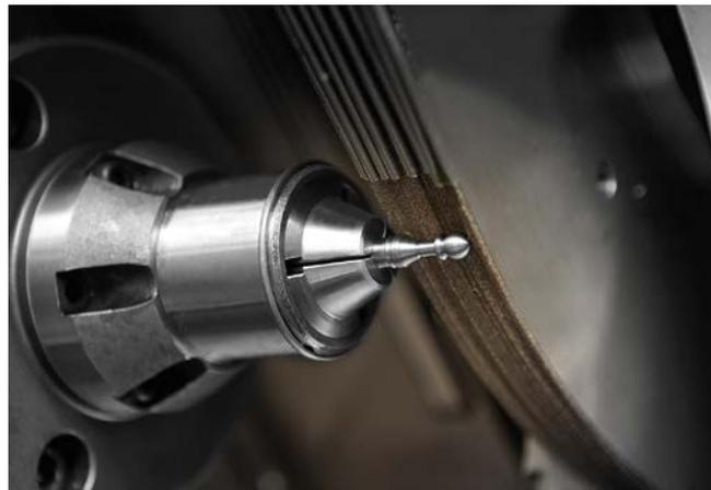
**3 Profilieren einer Schachfigur: Beim Schleifen ist die Herstellung butzenfreier Teile zu 100 Prozent garantiert; außerdem entstehen, anders als beim Drehen, keine Spanabdrücke** (© Junker)
