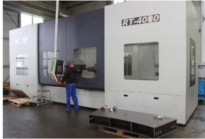
**3** Mit der neuen Bettfräsmaschine RT 4000 von MTE, gesteuert von einer Sinumerik 840D sl, schließt Lohnfertiger Endres die Lücke zwischen seinen kleinen und großen Fräsmaschinen, die allesamt mit Siemens-Steuerungen ausgestattet sind (© Siemens)
