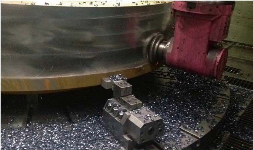
3 Beispielhaft: In Auswertung einer solchen Drehfräs-Operation mit einem Planfräser von ZCC-CT (Durchmesser 315 mm, 60°-Wendeschneidplatten) fiel der Entschluss bei Leipert, Fräswerkzeuge dieser Bauart in Zukunft zu präferieren (© Milltec GmbH)
