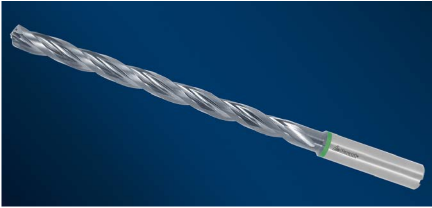
2 Ein dreischneidiger VHM-Bohrer der Ausführung Garant MasterSteel Feed mit spanflussoptimierter Ausspitzung für duktile Werkstoffe. Indem man seine Spiralsteigung optimierte, wurde nun ein L/D-Verhältnis von 12 \times D erreicht, ohne Abstriche bei der Prozesssicherheit machen zu müssen (© Hoffmann Group)
