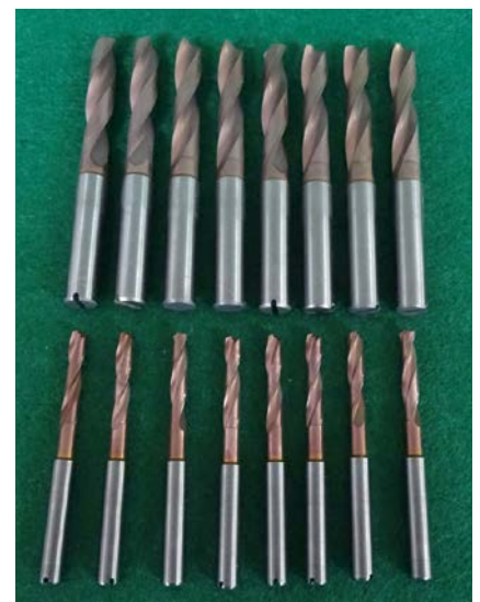
3 VHM-Bohrer, deren Spanfläche mit Metall-Nitriden und deren Freifläche mit Metall-Karbid veredelt wurde. In der Version mit 14 mm Durchmesser verlängerte sich ihre Standzeit beim Bohren von Grauguss GG25 weiter um den Faktor 3 bis 4
