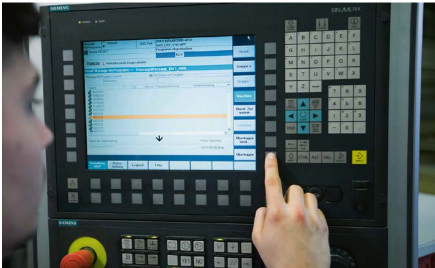
2 Von der Steuerungsoberfläche direkt auf die NC-Programme auf dem Server zugreifen und sie vor der Ausführung auf die Maschine überspielen, das funktioniert laut Mario Demertzoglou, Maschinenbediener, im Vergleich zum Vorgehen ohne Manage MyPrograms viel einfacher und viel schneller (© Siemens)
