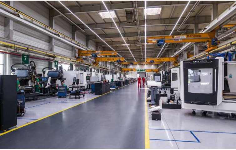
2 Die CMX 600 V und die CMX 800 V werden in Fließmontage gebaut, die größere CMX 1100 V in Boxmontage; Gleiches gilt für die Universalfräsmaschinen CMX 50 U und CMX 70 U zur 5-Seiten-Bearbeitung sowie die Universaldrehzentren CLX 350 und CLX 450
