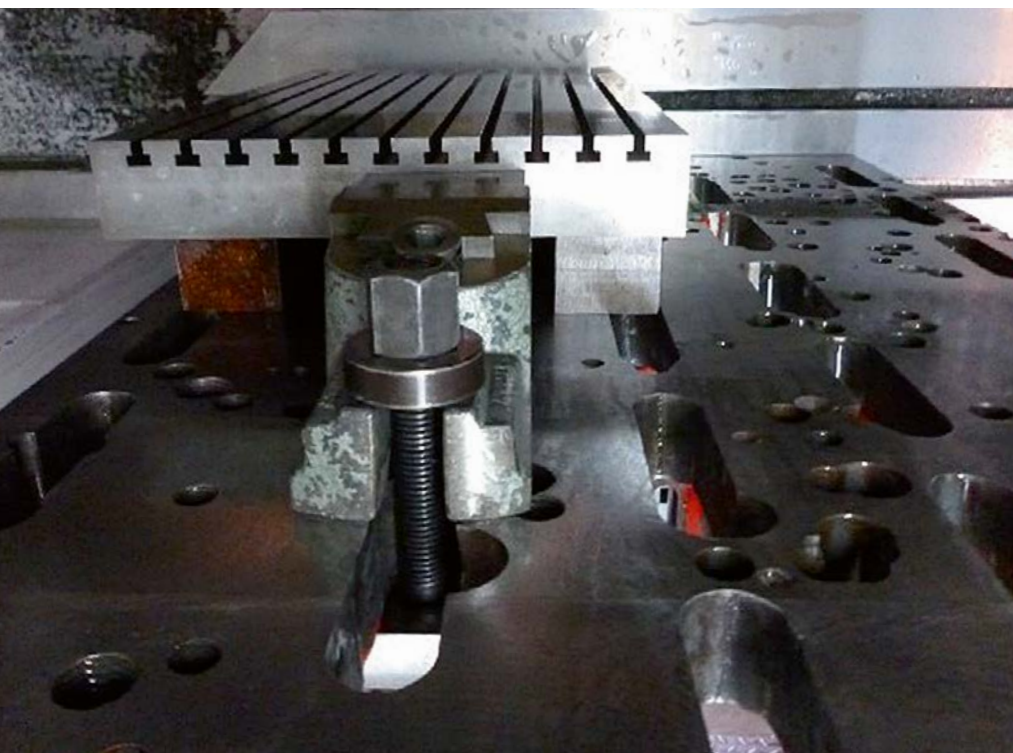
4 Einfach anmutend, anspruchsvoll zu fräsen: die jeweils 1000 mm langen 6-mm-Nuten des Aufspanntisches für Bumotec-Fräsmaschinen (oben). In dieser elfnutigen Tischausführung geht der »Neuner« zweimal übers Teil; dann wird jede Nut zum T gefräst (© Starrag)
