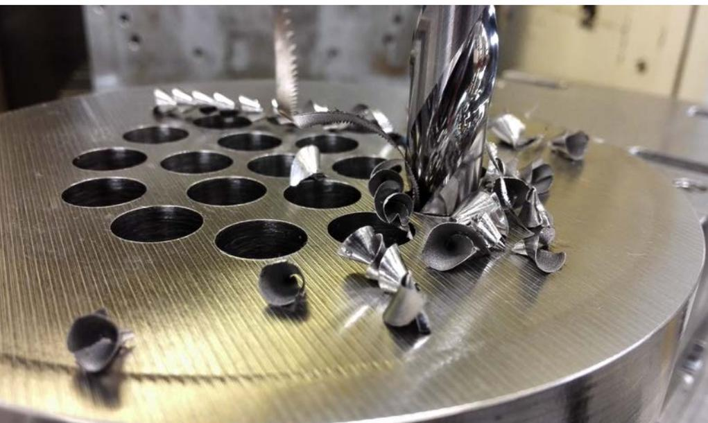
**1** Vermeintlich saubere Bohrprozesse in Inconel 718 zeigen oft eine unerwünschte Begleiterscheinung: von außen nicht sichtbare Fehlstellen an den Bohrungsändern, die die Funktion des gefertigten Bauteils beeinträchtigen können (© ISF)
