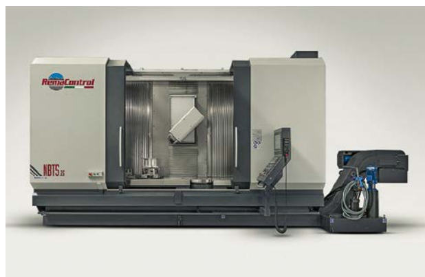
2 Der X-Weg der Newton Big NBT5.25 von RemaControl ist bis zu 12000 mm frei definierbar. Die Maschine kann im Pendelbetrieb arbeiten sowie wahlweise mit Schwenkkopf und mehreren Rundtischen ausgestattet werden
