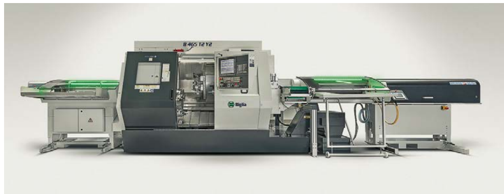
1 Das CNC-Drehzentrum Biglia B465T2Y2 mit zwei Revolvern und zwei Y-Achsen ist in diesem Fall mit Be- und Entladesystem für die Wellenbearbeitung ausgestattet
