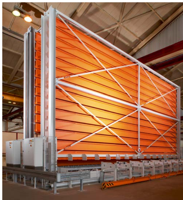
2 Turmlagersysteme wie der Unittower benötigen nur eine geringe Grundfläche. Dank Energierückgewinnung sind sie äußerst wirtschaftlich im Betrieb (© Kasto)
