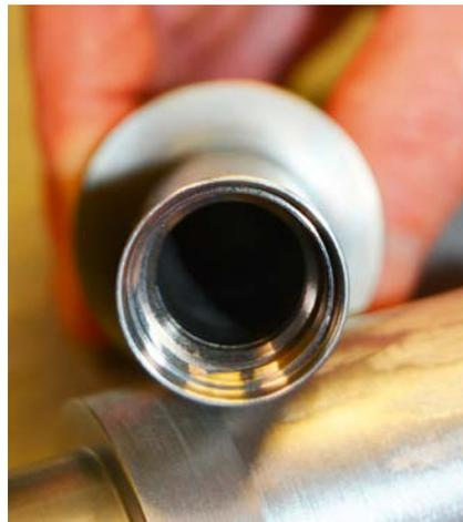
**3** Der Rotor erfordert wie zahlreiche andere Komponenten bei Siemens Healthcare Innenpassungen mit Toleranzen im Mikrometerbereich. Die daraus erwachsenden Probleme löst man in Rudolstadt durch intensive Zusammenarbeit mit Arno
