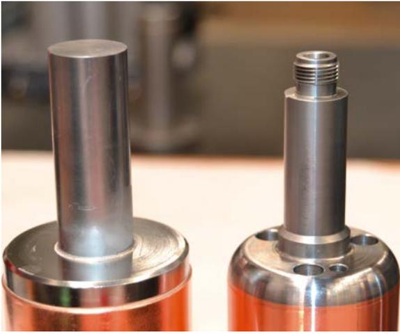
**2** Besonders anspruchsvoll ist es, Werkstücke aus einem Werkstoffmix vom Rohteil- (links) in den Fertigteilzustand zu überführen. Hier ein Rotor für Röntgenröhren, bei dem man Kupfer, Edelstahl und Molybdän kombinierte
