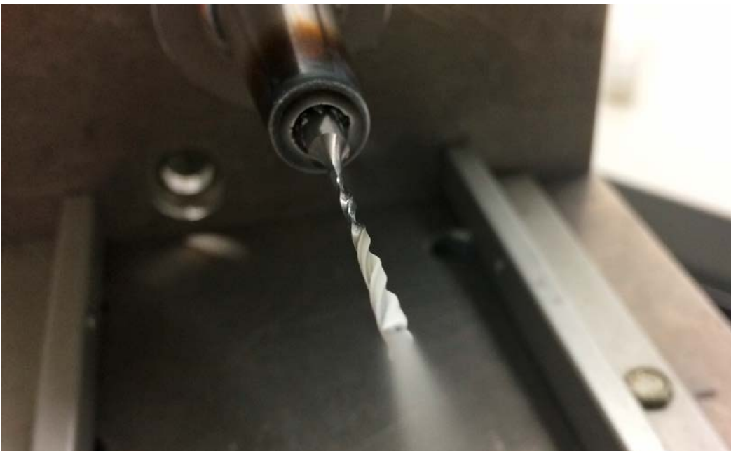
1 Kleinstbohrer mit austretendem Schmierstoffschnee-Strahl in einem Zerspanprozess mit kryogener Minimalmengenschmierung (kMMS) [© FH SWF]
