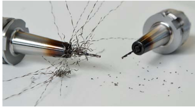
4 Qualitativer Vergleich der Späne nach dem Bohren von Inconel 718 mit eMMS (links) und mit kMMS (rechts)
