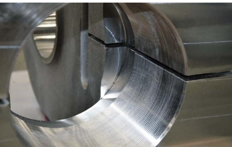
**2** Der Gabelkopf des Rohrhalters mit eingefrästem Schlitz. Das Formelement hat eine sehr gute Oberflächengüte, sodass sich die Nacharbeit auf ein Minimum reduziert (© Iscar)
