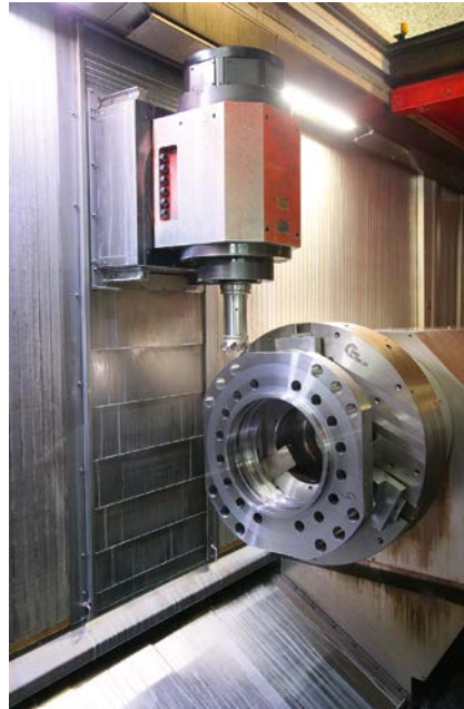
3 Ausgestattet mit Gegenspindel, Reitstockfunktion und Lünettenschlitten, können auf der Hyperturn 200 Werkstücke bis 1000 mm Drehdurchmesser, 4000 mm Bearbeitungslänge und 6000 kg Gewicht prozesssicher bearbeitet werden (© Emco)
