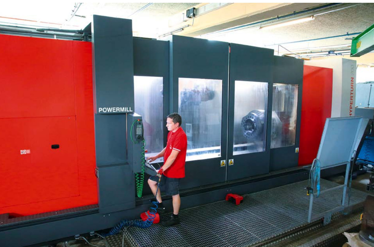
1 Beeindruckende Größe: Die Hyperturn 200 Powermill von Emco ist die größte Werkzeugmaschine bei GMT Wintersteller; auf ihr produziert der Lohnfertiger seit 2017 komplexe Großteile in einer Aufspannung (© Emco)
