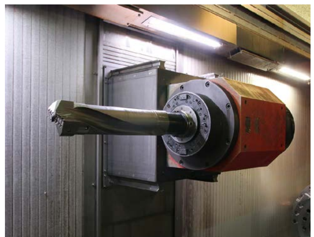
4 Für sehr hohe Zerspanungsleistung ausgelegt: Die Frässpindel bietet 630 Nm, Drehzahlen bis 6500 min -1 sowie 80 kW Antriebsleistung (© Emco)
