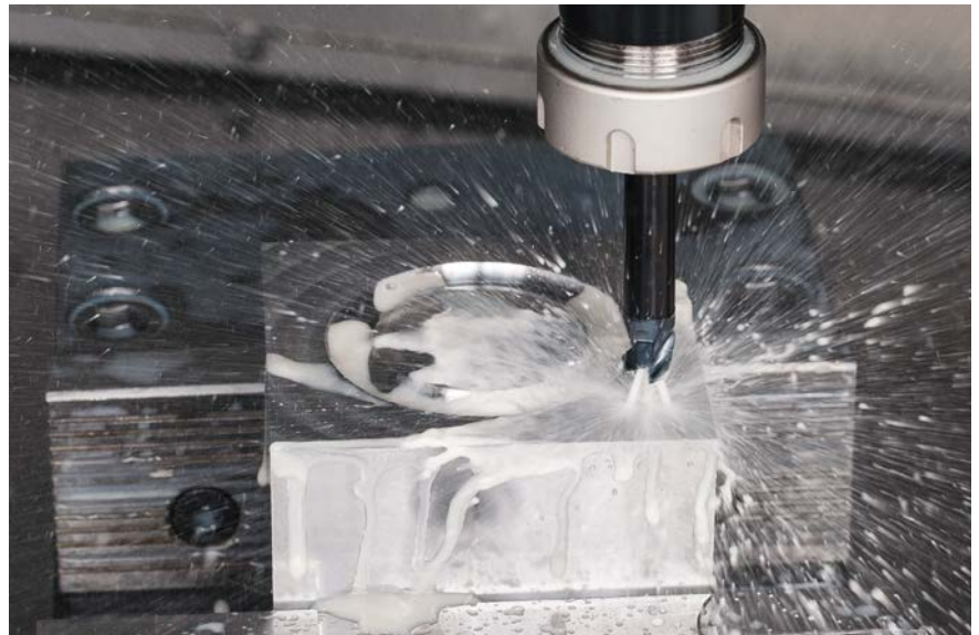
4 Der Multi-Master-Kugelfräser zum Hochvorschubfräsen ist ein modulares Werkzeug mit austauschbaren Vollhartmetallköpfen. Mit zentralen KSS-Bohrungen und progressiver Al-Tec-Beschichtung erreicht er ein Optimum bezüglich Verschleißfestigkeit und Zähigkeit
