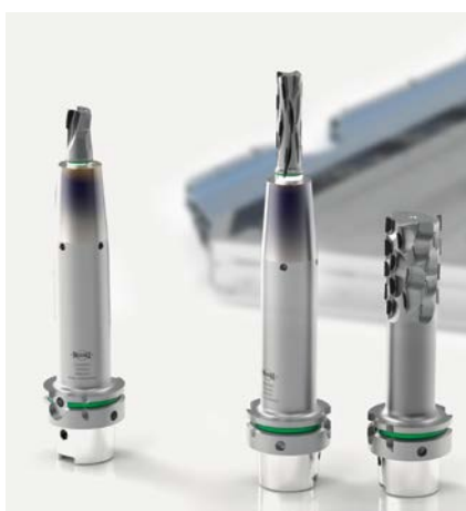
2 Der Aalener Werkzeugspezialist konzipiert auch für alle Varianten von Batteriegehäusen die Werkzeuge samt passender Bearbeitungsstrategie (© Mapal)
