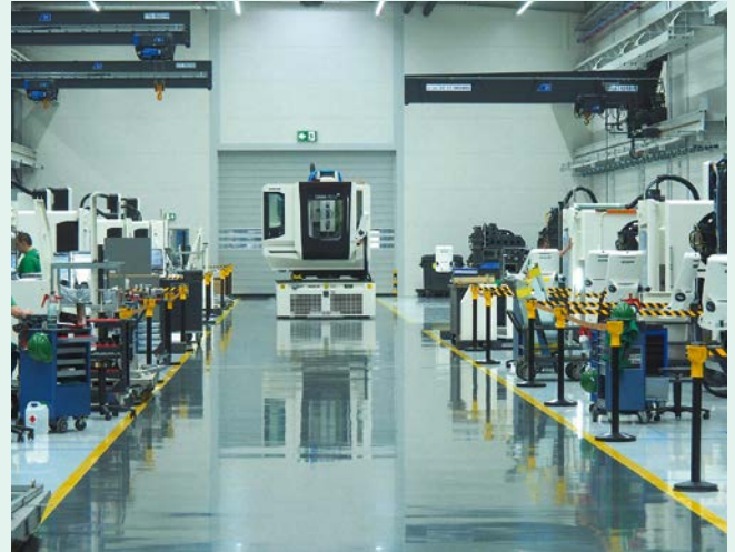
5 Eine Komplettmaschine wird von einem fahrerlosen Transportsystem zum Auslieferungsbereich gebracht (© Hanser)
