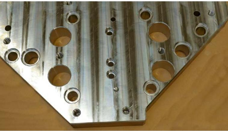
**2** Charakteristisches Aussehen einer Grund- oder Kopfplatte. Weil eine Vielzahl unterschiedlicher Bohrungen einzubringen ist, sind leistungsfähige Bohrwerkzeuge eine Voraussetzung für die Effizienz der gesamten Fertigung (© Ingersoll Werkzeuge)
