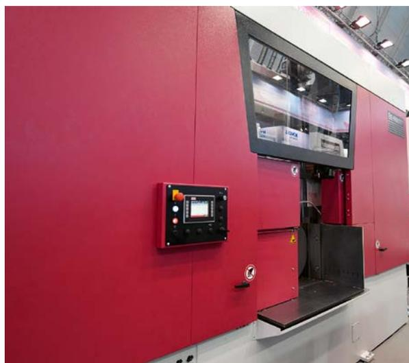
**2** Die Touch-Steuerung BT65 unterstützt den Bediener maximal bei der Arbeit: Nach Auswahl des zu sägenden Werkstoffs aus der Datenbank liefert die serienmäßige Auto-Feed-Control alle erforderlichen Technologiewerte für Schnittgeschwindigkeit und servogeregelten Vorschub (© Behringer)
