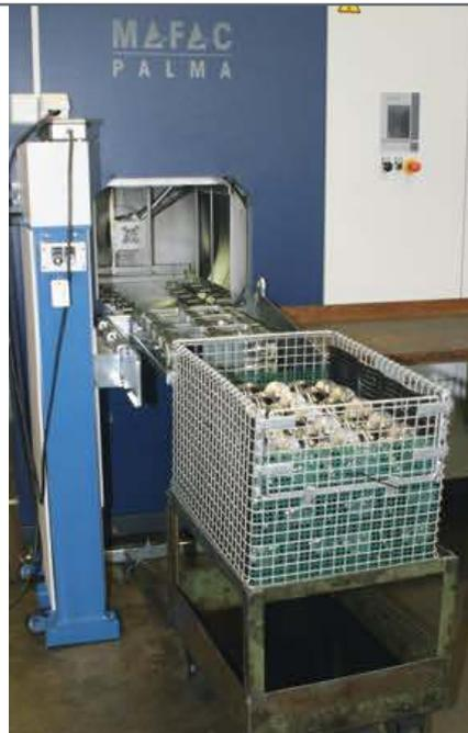
**3** Ein Blick ins Innere: Die Reinigungskammer der Anlage Palma wird komplett geflutet, und das Aufnahmesystem kann gleich oder gegenläufig zum Spritzsystem rotieren
