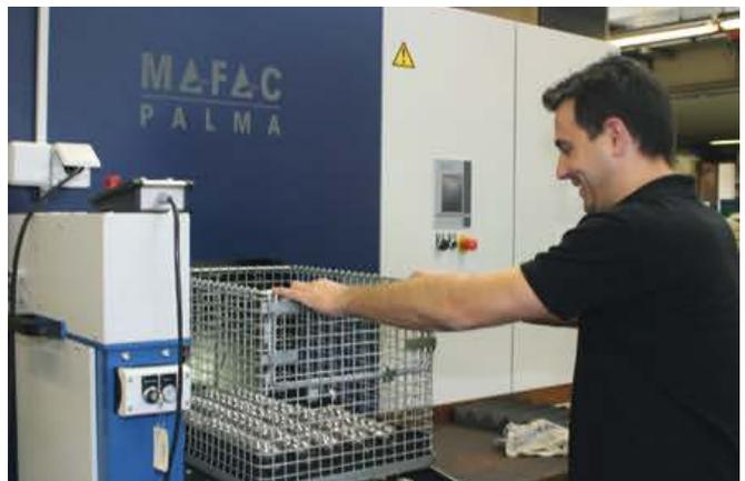
**2** »Ruhe an der Reinigungsfront«: Komplexe Werkstücke sind für die Anlage Palma ebensowenig ein Problem wie sehr schwere Körbe von bis zu 250 Kilogramm und eine große Packungsdichte
