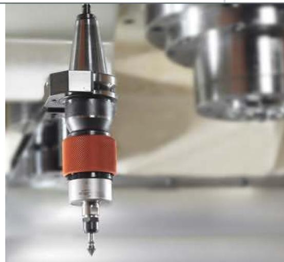
Das Entgratsystem engraflexx EC wird wie ein konventionelles Werkzeug über den Werkzeugwechsler eingewechselt
